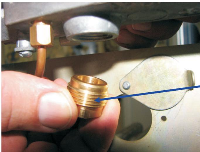
Откручиваем и снимаем переходник магнитной пробки
