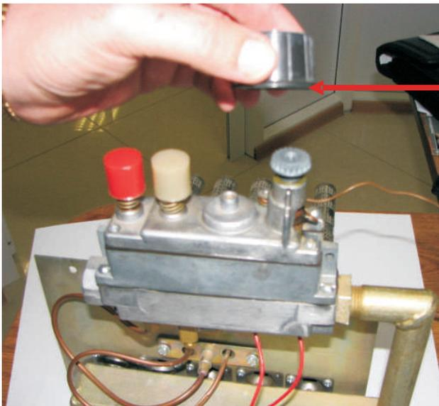
Снимаем ручку автоматики безопасности
