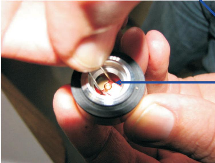
Регулируем усилие прижима щелчковой пружины. Необходимо добиться срабатывания клапана малого пламени щелчком.
