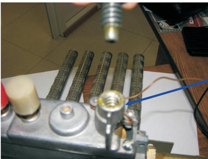
Выкручиваем винт настройки
