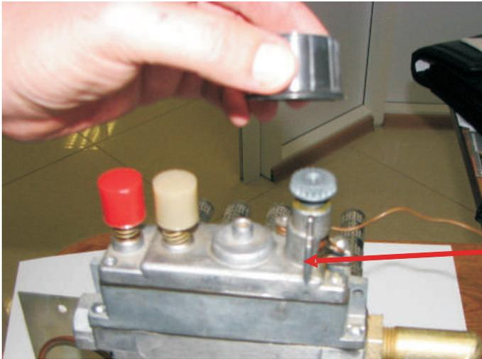
Устанавливаем ручку на против прилива в позиции выключено. Закручиваем винт М4.
