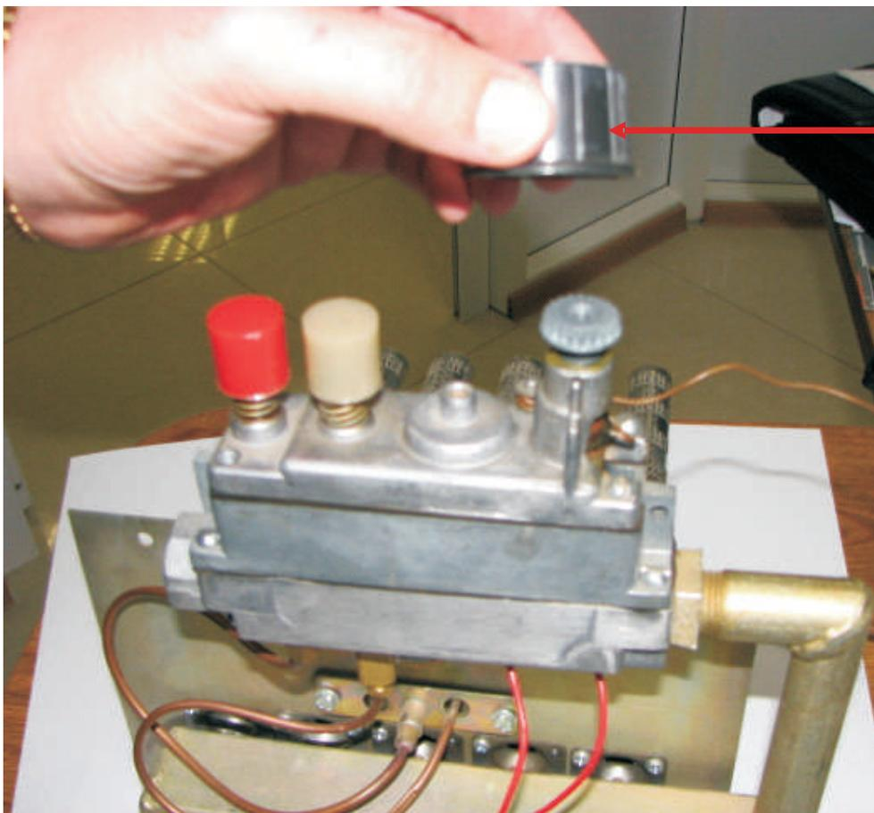
Снимаем ручку автоматики безопасности
