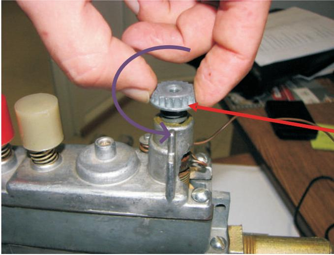
!!! Данная операция производится на холодном котле или со снятым термодатчиком
