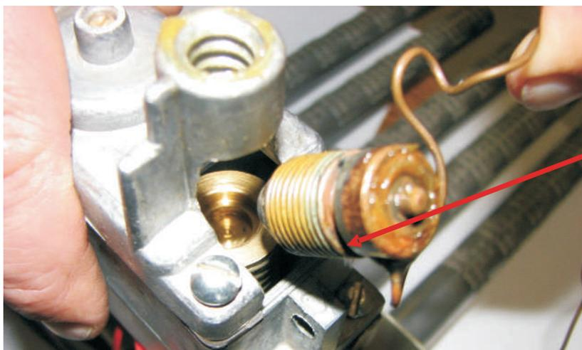
Снимаем сиффон термодатчика
