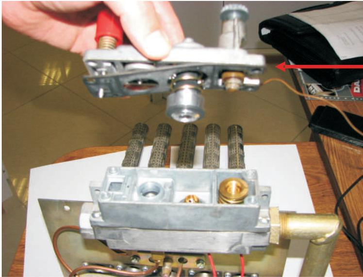
Снимаем верхний корпус автоматики безопасности
